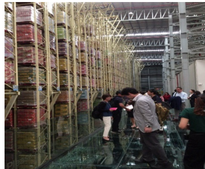
立体自動倉庫
